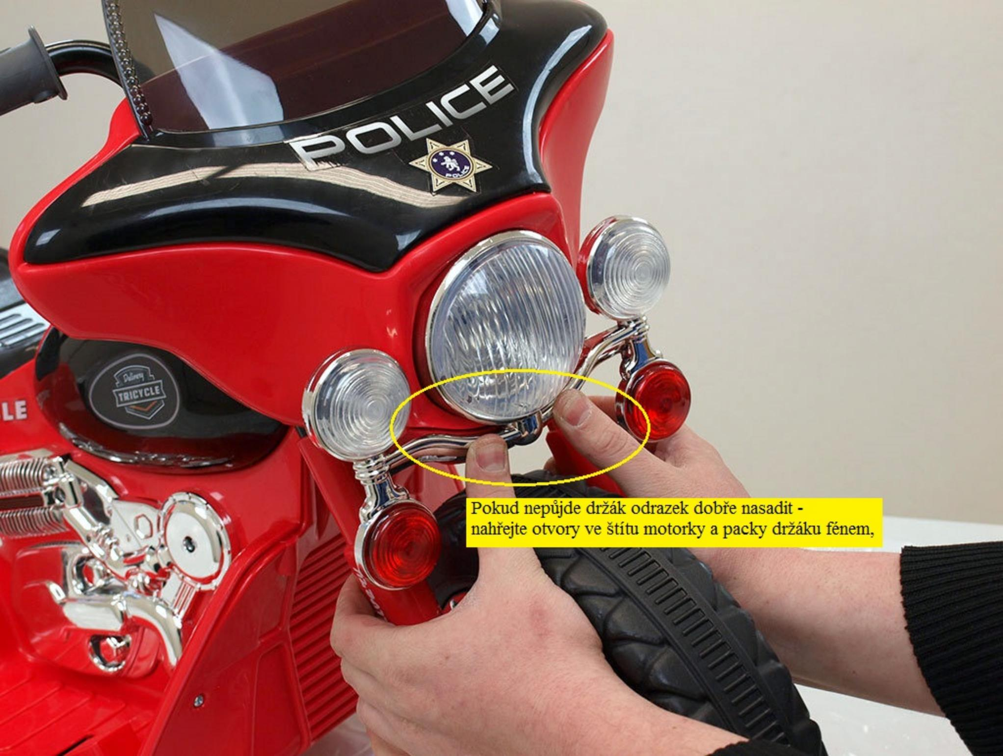
Pokud nepůjde držák odrazek dobře nasadit - nahřejte otvory ve štítu motorky a packy držáku fénem,
